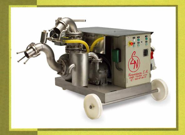
POMPA per l'estrazione e trasporto delle olive di fermentatori sotterranei
