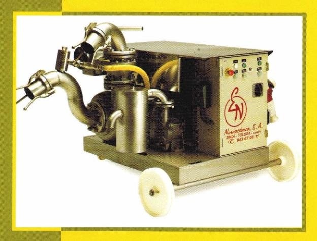
POMPE d'extraction et transvasement d'olives provenant de fermenteurs souterrains
